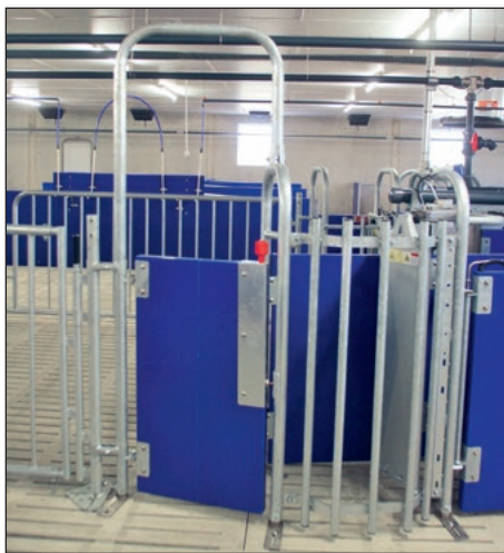
Направляващи рамки – по-лесно влизане в станцията
