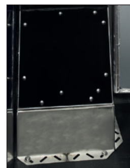
Хранително корито от неръждавейка – клапата на коритото отворена/затворена
